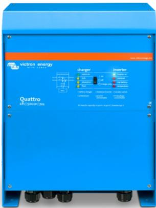
Los inversores de voltaje son los que transforman la corriente continua (CC) de baja tensión (12V, 24V, 32V 36V ó 48V) en corriente alterna (AC) de alta tensión (110V, 220V). El Quattro puede conectarse a dos fuentes de alimentación CA independientes, por ejemplo a la red del pantalán o a un generador, o a dos generadores. Se conectará automáticamente a la fuente de alimentación activa.
