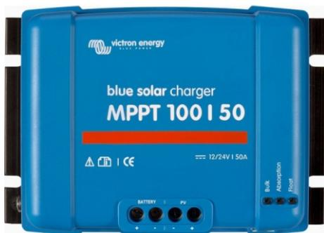
El controlador de carga BlueSolar MPPT puede cargar una batería de tensión nominal inferior a partir de unas placas FV de tensión nominal superior. Especialmente con cielos nubosos, cuando la intensidad de la luz cambia continuamente, un controlador MPPT ultrarrápido mejorará la recogida de energía hasta en un 30%, en comparación con los controladores de carga PWM, y hasta en un 10% en comparación con controladores MPPT más lentos.
